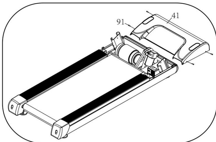
Используйте крестовую отвертку, чтобы снять верхний кожух моторного отсека (41) с основной рамы.
