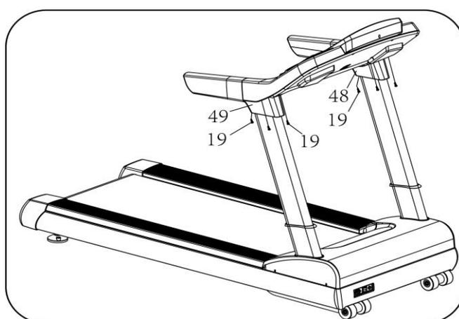
Прижмите левую крышку стойки консоли (48), чтобы убедиться, что хорошо соприкасается с кожухом консоли, а затем используйте ключ, чтобы зафиксировать левую крышку стойки консоли (48) к раме консоли с помощью болта (19) и болта ST4 0,2 \* 19 (29).
