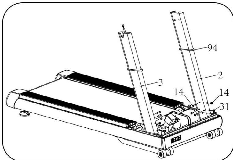
Используйте 6 # шестигранный ключ, и приверните правую и левую стойки консоли (2/3) к основной раме (1) с помощью болтов M10 \* 20 (14) и шайб (31). Как показано на рисунке.
