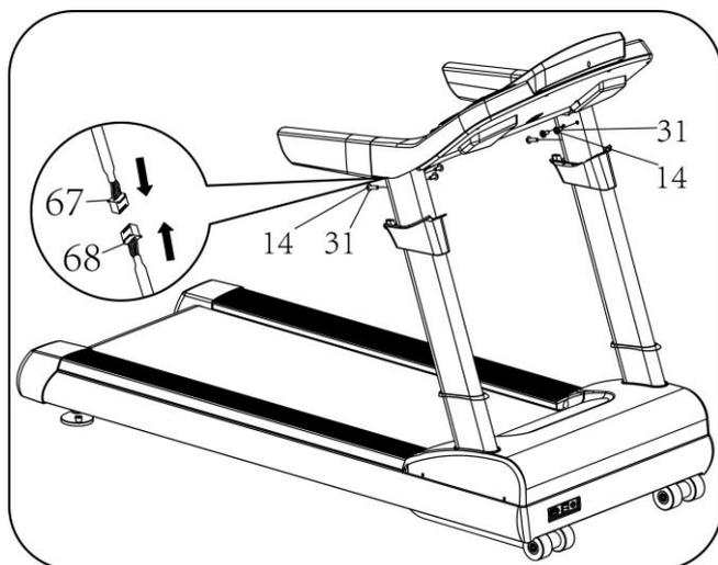
1. Используя 6 # шестигранный ключ, закрепите консоль на левой и правой стойках консоли с помощью болтов М10 \* 20 (14) и шайб (31).
