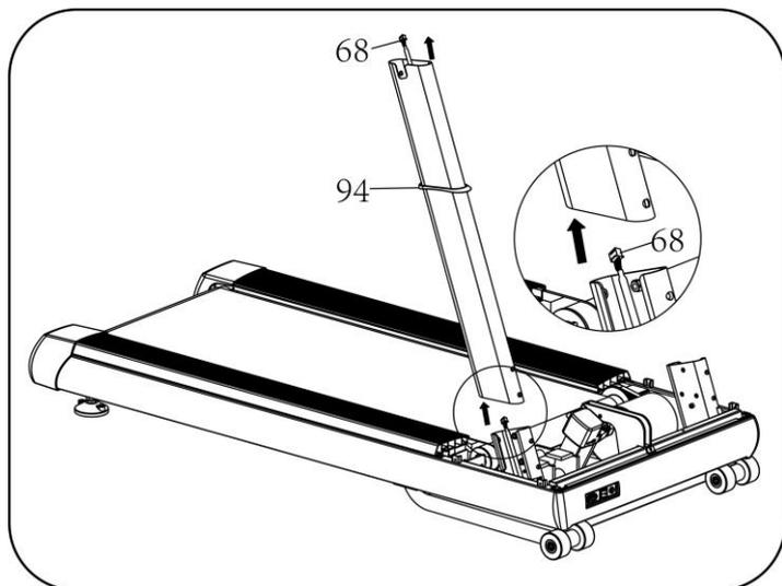
Пожалуйста, протяните через правую стойку консоли (3), нижний кабель консоли (68) снизу вверх.
